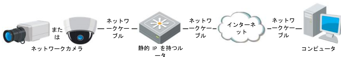
図 2-10 静的 IP を持つルータを経由したカメラへのアクセス
